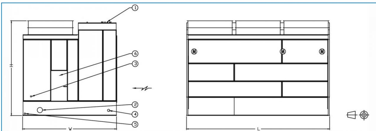
1. Wassereintritt; 2. Wasseraustritt; 3. Frischwasser; 4. Überlauf ND80; 5. Ablauf ND50; 6. Zugangstür.
