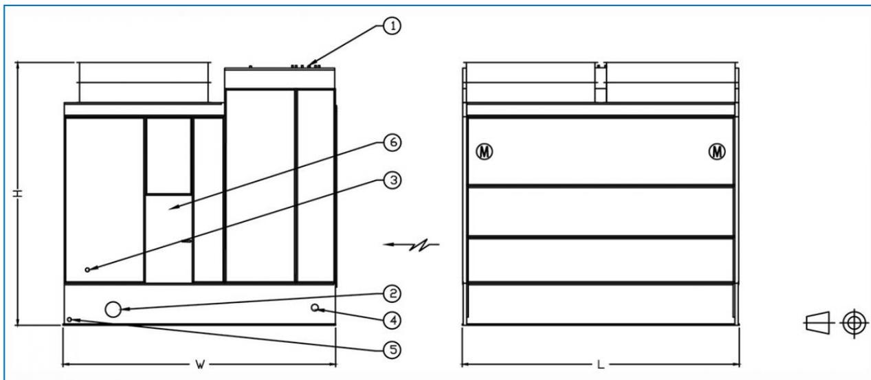
1. Wassereintritt; 2. Wasseraustritt; 3. Frischwasser; 4. Überlauf ND80; 5. Ablauf ND50; 6. Zugangstür.
