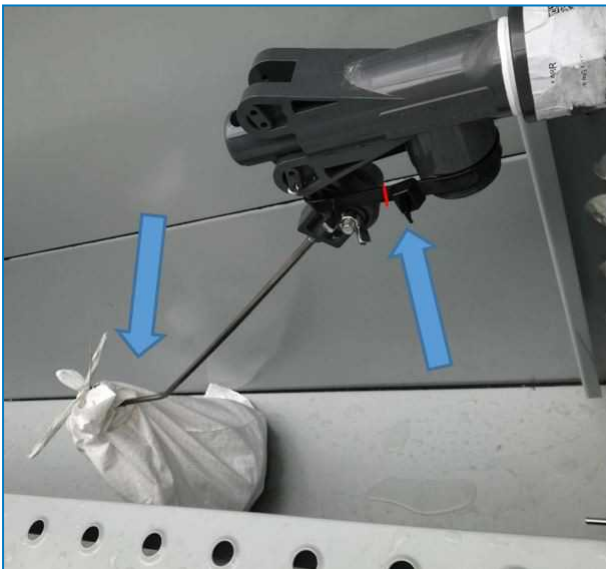
Befestigung und Umhüllung der Schwimmerkugel
