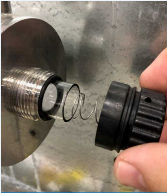
Entfernen des UV-Quarzhüllrohrs
