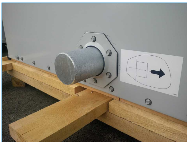
Attacco batteria chiusura inferiore sui condensatori evaporativi.
