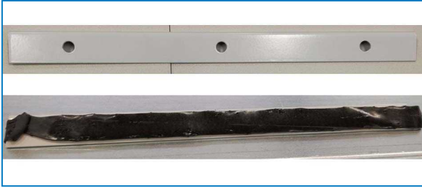
Un profil d'étanchéité avec joint d'étanchéité en butyl
