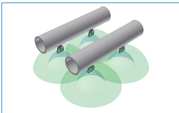
Tipo de boquilla de pulverización para torre de enfriamiento de circuito cerrado
