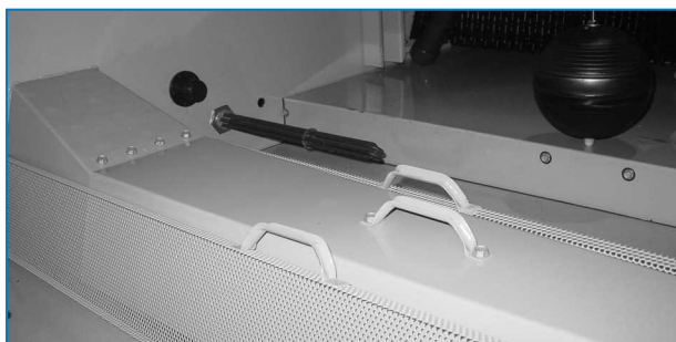
Bassin d'eau froide et tamis
