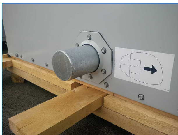
Attacco batteria chiusura inferiore sui condensatori evaporativi.
