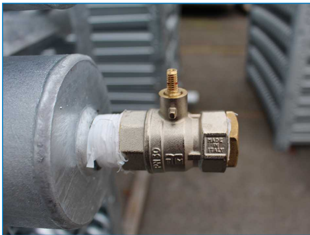
Attacco batteria superiore con valvola limitatrice di pressione sui condensatori.
