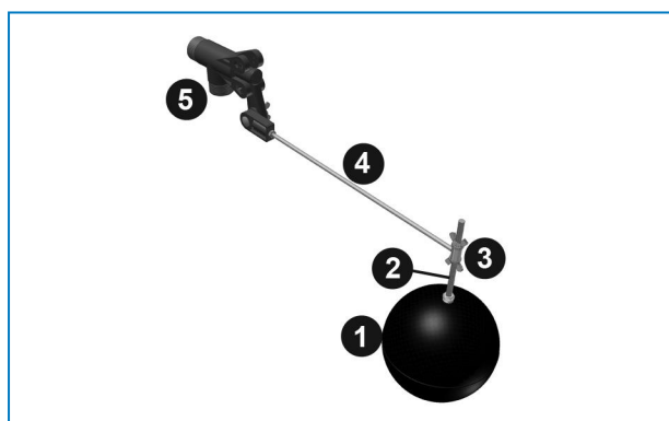
Узел клапана подпитки водой
