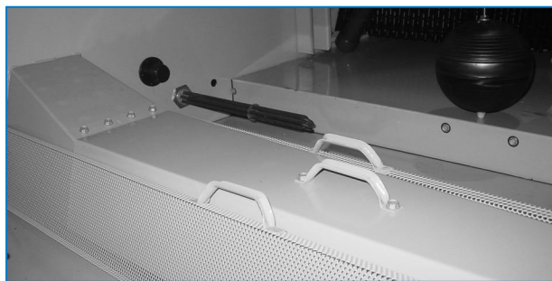
Бассейн холодной воды и сетчатый фильтр бассейна
