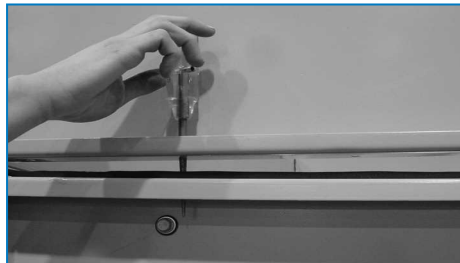
Использование штифта для выравнивания резьбовых отверстий
