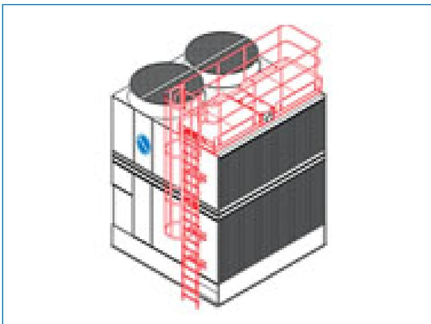
La escalerilla, la jaula de seguridad y la barandilla se instalan **facilitar el acceso a la parte superior de la unidad**, la inspección y el mantenimiento de acuerdo con **las directivas de seguridad de la UE**. Las unidades equipadas con estas opciones disponen también de [tapas de la bandeja de distribución](#).
