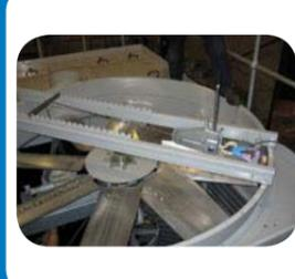
Système de démontage de l'équipement mécanique
